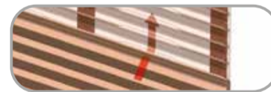
Voorzien van verborgen ventilatie (= VentiWood®) = voorkomt schimmel
