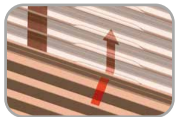
Verborgen ventilatie = voorkomt schimmel
